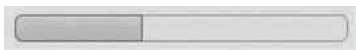
图 11-8 通过从左向右“填充”控件来展示操作完成百分比的进度条
