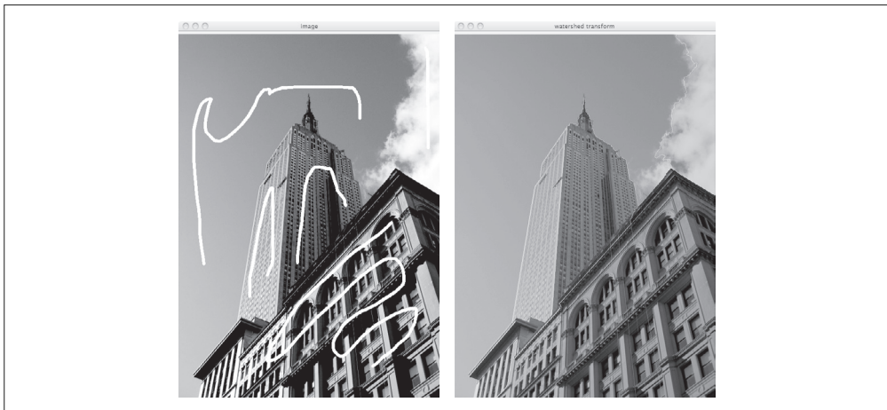
图 10-9：用分水岭变换分割图像。左图是画有种子区域的输入图像，右图显示了分割结果，分割区域用不同的颜色覆盖
