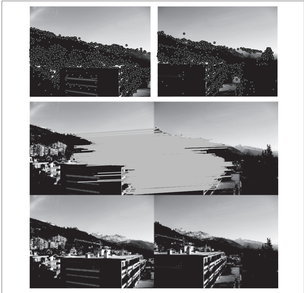
图 2-5：在两幅图像间检测和匹配 SIFT 特征
