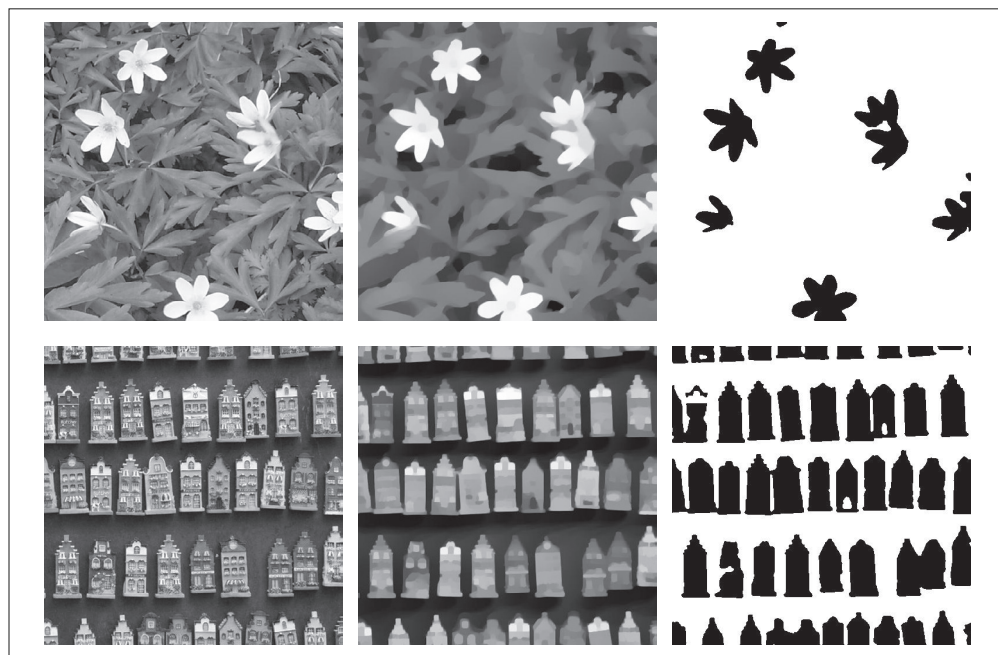
图 9-8：利用 ROF 降噪最小化 Chan-Vese 模型的一些图像分割示例：(a) 为原始图像；(b) 为经过 ROF 降噪后的图像；(c) 为最终分割结果
