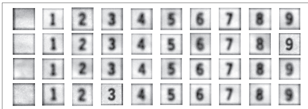
图 8-6: 用于训练 10 类数独 OCR 分类器的训练样本图像
