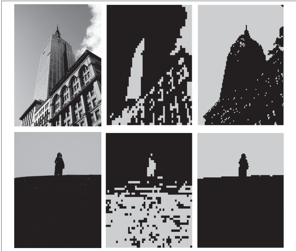
图 6-4：基于颜色像素值用 K-means 对像素进行聚类的结果。左边是原始图像；中间是用 k=3 和 50 \times 50 大小的窗口进行聚类的结果；右边是用 k=3 和 100 \times 100 大小的窗口进行聚类的结果
