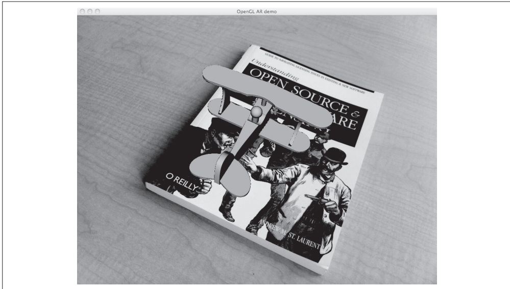
图 4-6: 从 .obj 文件载入三维模型, 并使用由特征匹配计算出的照相机参数将其放置在书本上
