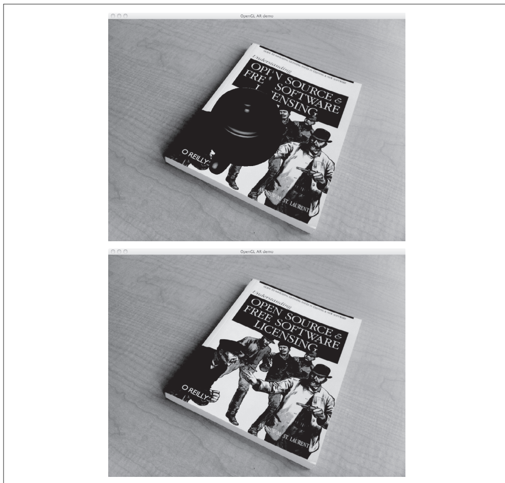
图 4-5：增强现实。使用由特征匹配计算出的照相机参数，将一个计算机图形学模型放置在场景中的书本上：将 Utah 茶壶按照和坐标轴对齐的方式显示出来（上）；进行合理性验证，查看原点的位置（下）
