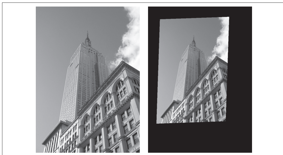
图 3-1：用仿射变换扭曲图像。原始图像（左图）以及使用 ndimage.affine_transform() 函数扭曲后的图像（右图）
