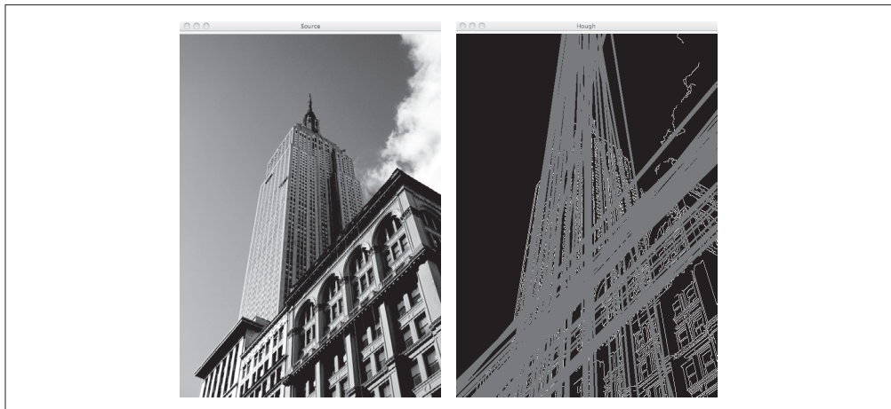
图 10-10：利用霍夫变换检测直线。左图是原图像经变换后的灰度图像，右图显示了检测到的直线
