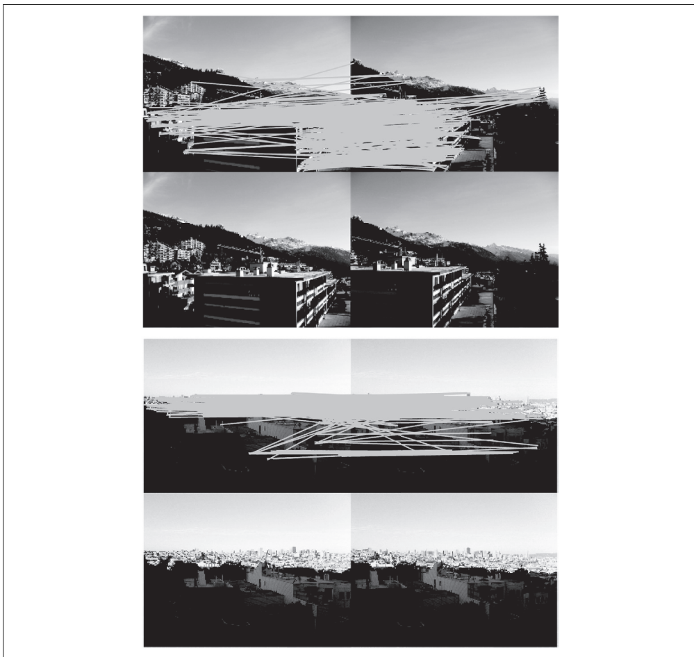
图 2-2: 将归一化的互相关矩阵应用于 Harris 角点周围图像块, 来寻找匹配对应点
