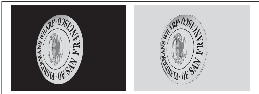
图 10-2: 彩色图像泛洪填充。在左上角用单个种子进行泛洪填充，右图高亮区域标出了所有填充了的像素
