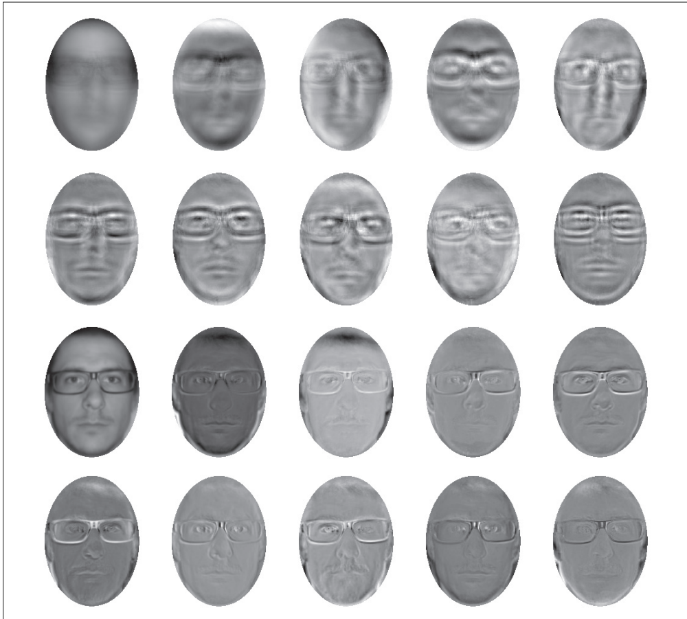
图 3-8：比较未配准和已配准图像的 PCA 模式：未经过配准的平均图像和前 9 个主成分（上）；经过配准后的平均图像和前 9 个主成分（下）
