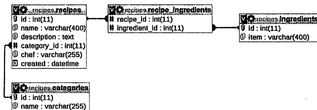
图 2.3 用 recipe_ingredients 表链接 recipes 表和 ingredients 表的数据库架构图
