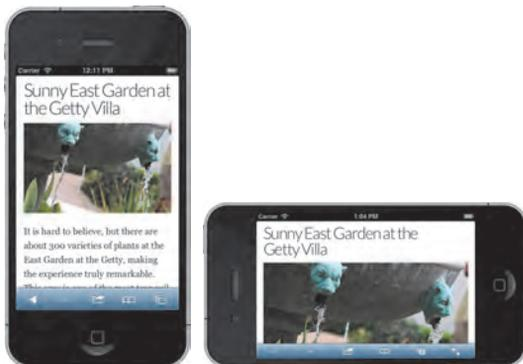
图 12.2.6 我们在本章将要创建的响应式页面在 320 像素宽的区域（左）和 480 像素宽的区域（右）中显示的样子。图像会缩放以适应容器！
