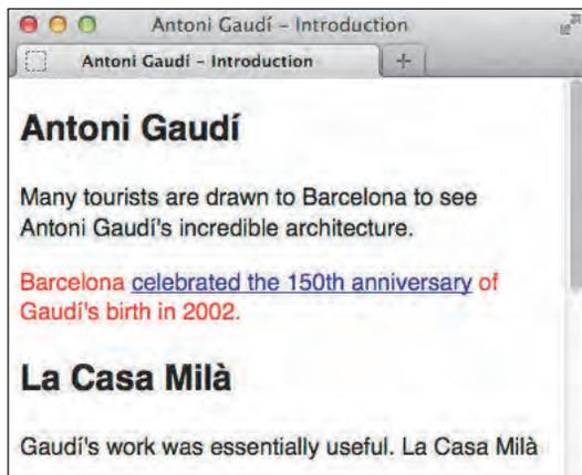
图 9.4.8 只有直接跟在同胞 p 元素后面的 p 元素显示为红色。如果后面还有第三个、第四个以及更多的段落, 它们也将显示为红色。例如, 如果要删除第一个段落以外的所有段落进行缩进, 相邻同胞结合符就很有用
