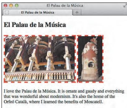
图 8.5.3 style 元素中定义的虚线边框优先于链接的 style.css 中定义的实线边框，不过保留了 style.css 中指定的边框宽度和颜色
