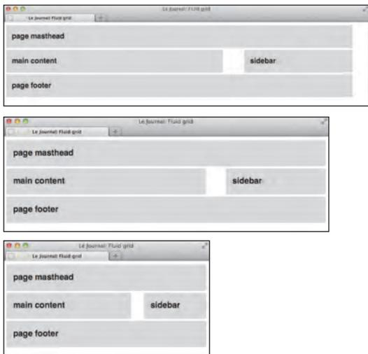
图 12.3.7 无论页面的视觉区域有多宽，两栏始终保持各自所占的比例。如果可视区域宽度超过 960 像素，页面就停止变宽，如最上面的图所示
