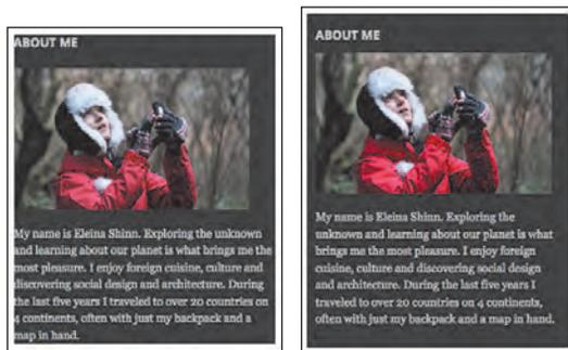
图 11.8.2 如果不设置内边距（左），内容就会贴到边界。添加内边距后，元素里的内容外围就会产生一些空白（右）。同时，在内边距的区域会显示背景色。（如果添加 `.about { border: 1px solid red; }`，则整个盒子的外围会显示一条红色的边框，边框位于内边距的外面。）可以看到，这个模块的上边和下边的空白要大于内边距指定的大小。这是由于浏览器为标题（ABOUT ME）设置的默认上下边距和为段落（如图像下面的段落）设置的默认下外边距造成的。它们外围的 `.about` 盒子的内边距让这些外边距在盒子内部生效
