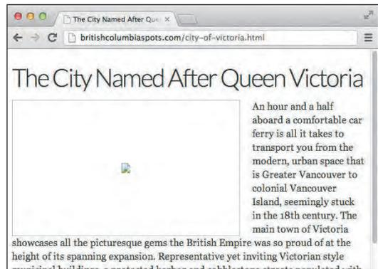
图 20.7.2 在你的计算机上，如果系统不区分文件名的大小写，页面看起来就没有问题。但将页面发布到区分大小写的服务器上以后，便无法找到图像。像 Chrome 这种浏览器就只会显示一个破碎图标
