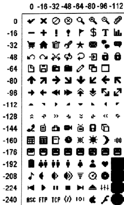
图14-1 bt.gif使用的16像素×16像素精灵图图片的偏移量
