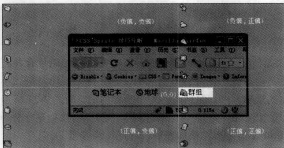
图 7-25 以四象原理分析 CSS Sprite 定位
