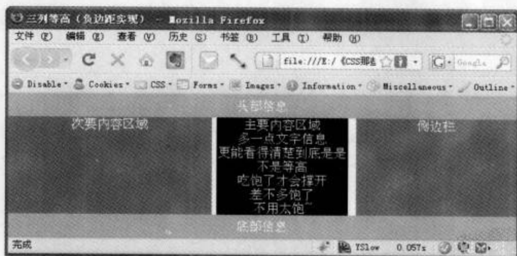
图 5-22 负边距实现三列等高且自适应宽度的页面效果
