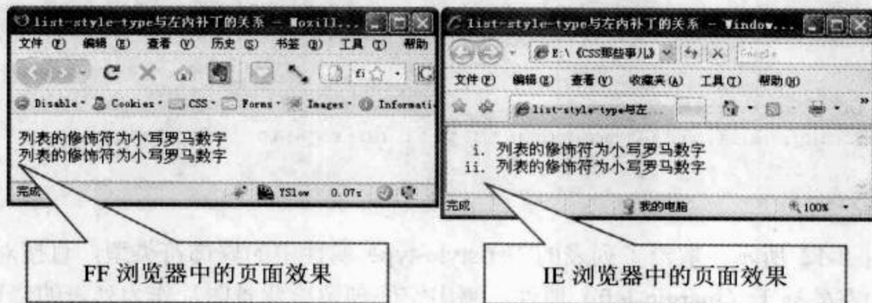
图 8-10 list-style-type 与左内补丁（padding-left）之间的关系
