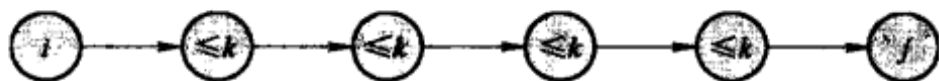
图 12-33 从 i 到 j 的最短路径，路径上的结点皆属于 \{1, 2, \dots, k\}
