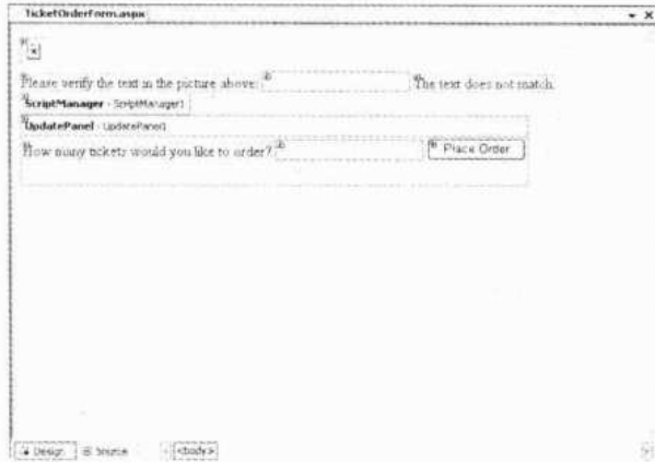
图 15-3 在 ASP.NET Web 表单中使用 CAPTCHA 验证程序
