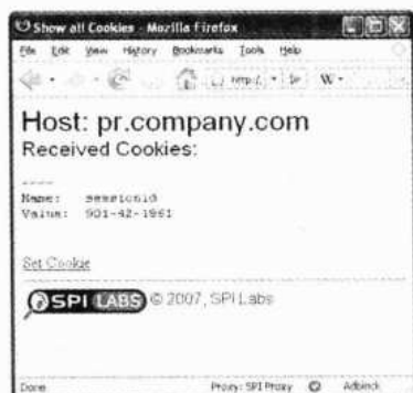
图 8-8 通过设置恰当的 Domain 属性，pr.company.com 可以访问 sales.company.com 的 cookie
