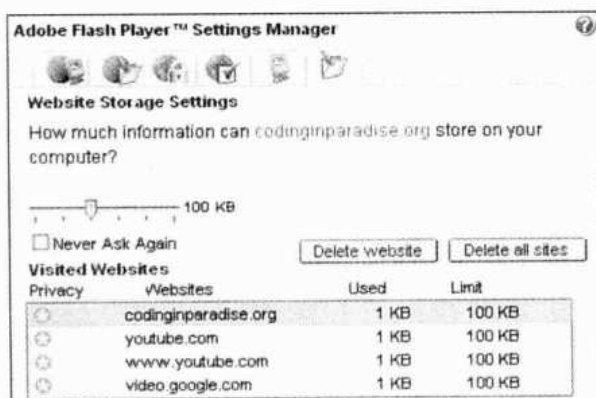
图 8-13 通过 Flash Player 的设置管理器可以删除掉一个或多个的 LSO
