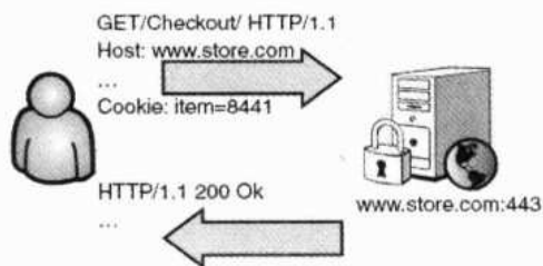
图 8-4 该 cookie 还可以通过同一域的不同端口发送给一台使用 SSL 的 Web 服务器
