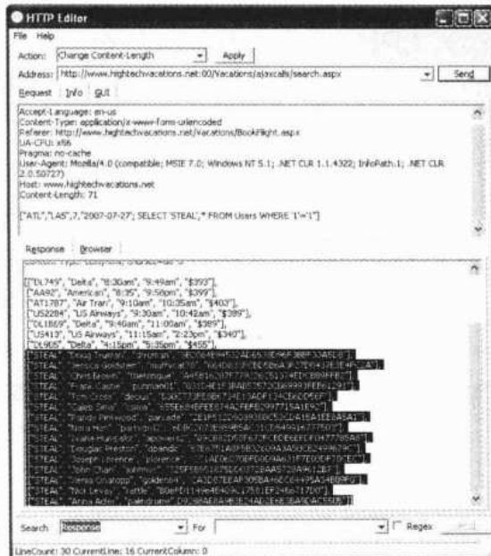
图 2-7 Eve 只通过一条简单的查询语句，便获得了 Users 表中的所有数据
