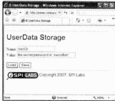
图 8-21 示例程序将“secr3t”这样的敏感信息存储在了 userData 中
