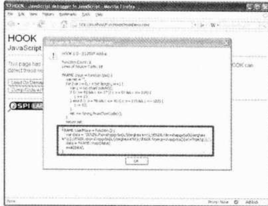
图 7-8 HOOK 通过对 window 对象进行枚举迭代，提取出了 FRAME 框架中由用户定义的两个方法
