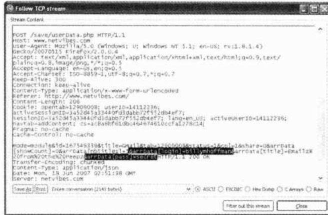
图 11-20 从捕获的网络传输数据可以看出，Gamil 用户名和密码以不安全的方式发送给了聚合网站 NetVibes.com
