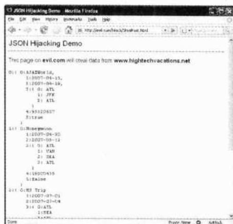
图 7-13 evil.com 已经成功地通过 JSON 劫持，窃取了 Alice 过去在 HighTechVacations.net 的旅行记录
