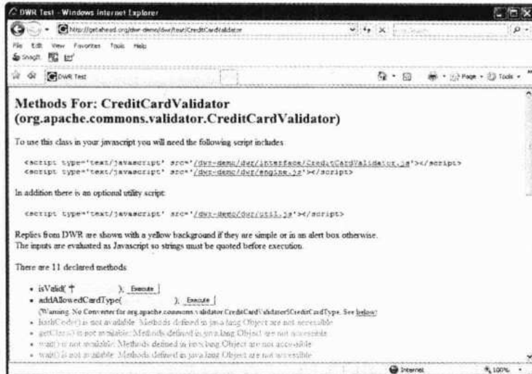
图 15-8 DWR 允许用户直接向暴露的服务端方法发送测试请求
