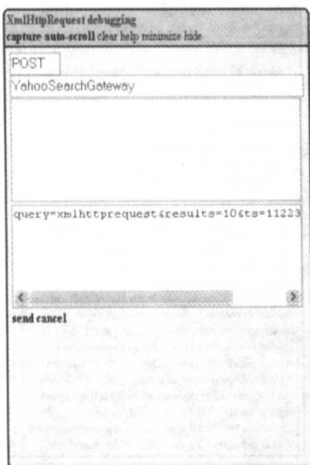
图 7-3 前一个例子的请求修改为使用 POST 方法，查询串从 URL 移到请求体中
