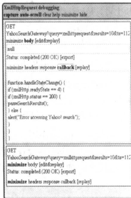
图 7-2 显示请求和响应（左）以及 XMLHttpRequest 对象的回调函数（右）
