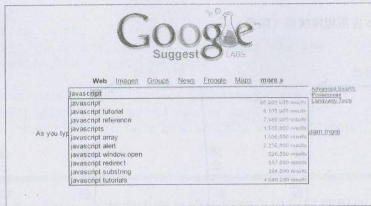
图1-4 Google Suggest的截图。Google Suggest是在Garrett的Ajax一文出现之前就存在的应用程序，运用了异步XML技巧
