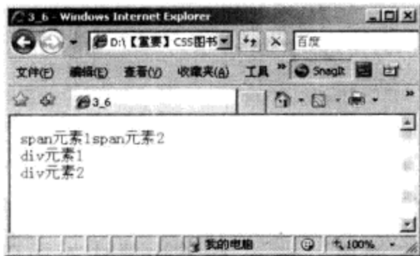
图 3-13 span 和 div 的区别
