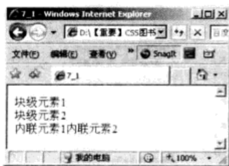
图 7-2 display 属性的 3 个属性值的效果
