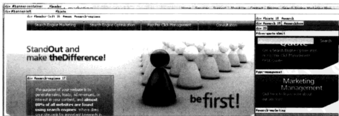
图 18-11 banner 区域 CSS 样式结构与 div 层级关系
