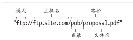
图 1.7.3 当用户点击这个 URL 时，浏览器会开始按 FTP 模式传输文件 proposal.pdf（有时需要先输入用户名和密码）
