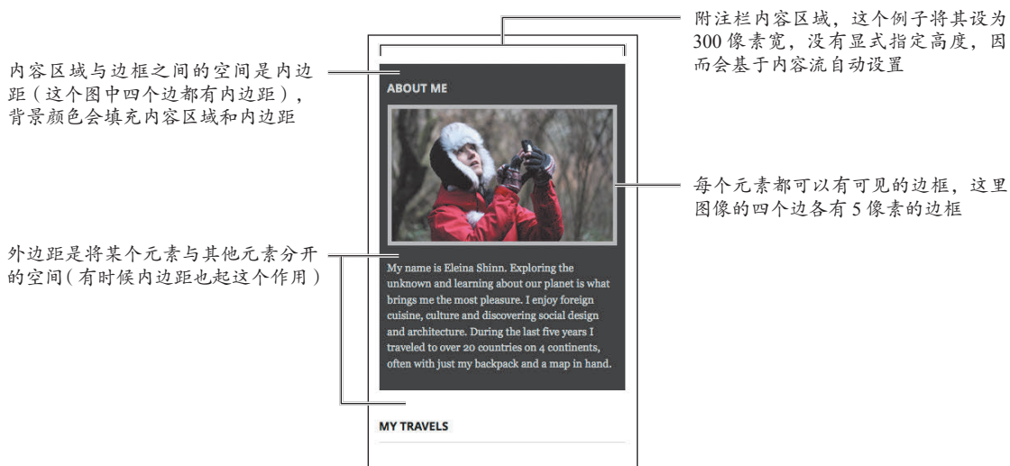
图 11.5.2 示例页面中附注栏的盒模型。记住，每个元素都有自己的盒子。例如，这里显示的 img 元素有边框，而它左右的空间则是包含该图像的 article 元素的内边距
