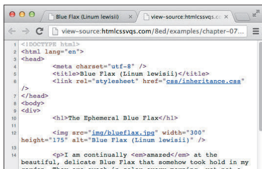
图 2.8.3 现代浏览器在其自身的选项卡或窗口中显示源代码（如图所示），而旧的浏览器可能在特定的文本编辑器中显示。页面内容的颜色与 HTML 元素、属性和属性值的颜色是区分开来的。这称为语法高亮（syntax highlighting）。左侧显示的行号并不是 HTML 代码的一部分，也并非所有的浏览器都会在 View Source 模式中显示行号
