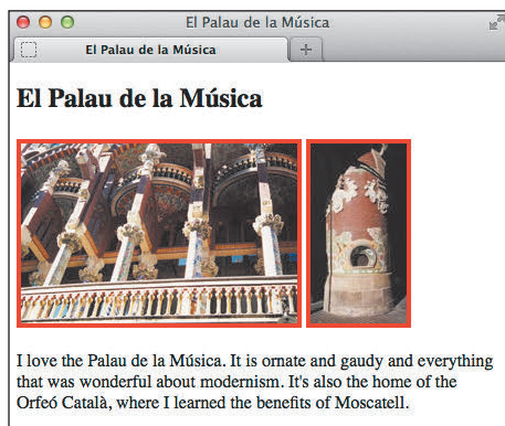
图 8.3.2 结果与链接到外部样式表完全一样。区别在于，其他网页无法利用这个页面中定义的样式
