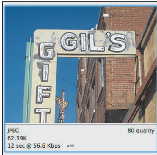
图 5.4.4 这里的修改反映的是左下方的区块。如果保存它，其大小就是 62.39K，尽管在图 5.4.2 中它只有 19.44K，但现在它的边缘更锐利了，这种质量上的提升是值得的。这里还修改了其他两个区块的设置。PNG-8（右上）的压缩让图像的像素化程度加深了，而且文件大小（70.56K）也比 JPEG 要大。PNG-24（右下）保持了很高的质量，但文件大小（224.3K）也大得多。显然，JPEG 是保存照片的最佳选择
