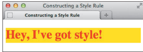
图 7.1.4 标题从浏览器默认的白色背景、黑色文字样式变为黄色背景、红色文字
