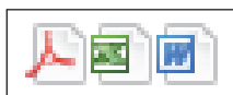
图 14.10.2 这个 sprite 图像包含三个图标，每个都是 16 像素 × 16 像素大小，相邻两个之间有 2 像素的空隙
