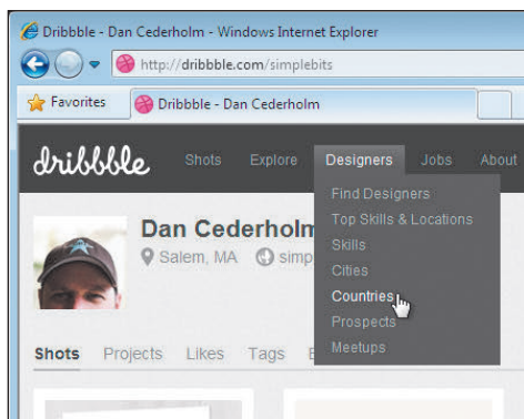
图 14.1.3 在不支持 border-radius 或 box-shadow 的旧浏览器（如 Internet Explorer 8）中查看该网站，体验就会发生改变。下拉菜单中各项的渐阴影不见了，圆角变成直角了，但功能并未损失，一切照常工作。这是渐进增强在实践中的一个方面
