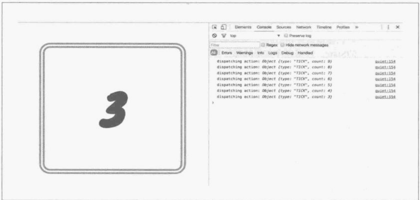
图7-8：采用Flux架构的倒计时程序
