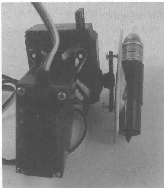
图 9-7 将激光指示器安装到舵机上
