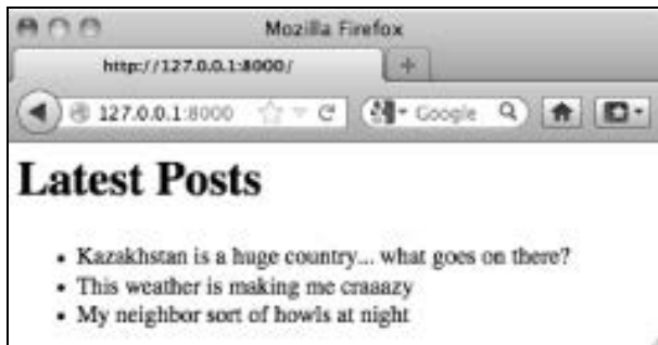
图3-7 来自Web服务器的HTML响应，从JSON文件中获取标题并返回一个Web页面
