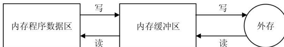
图13-1 数据通过缓冲区读取示意图
