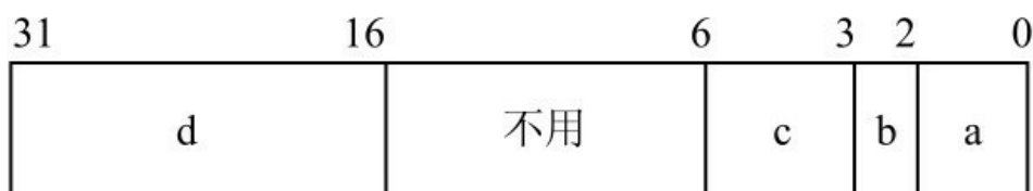
图11-3 位域结构存储示意图
