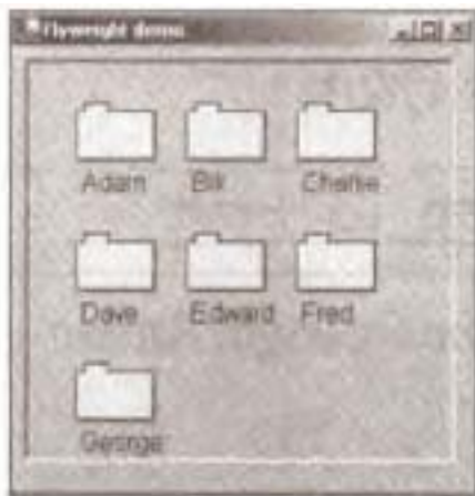
图 19.1 表示不同人的信息的一系列文件夹。由于它们很相似，适合于使用享元模式
