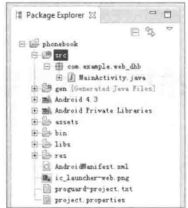
▲图 25-3 Android 项目的目录结构
