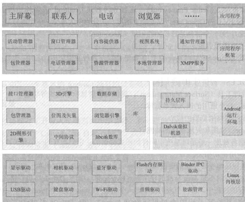
▲图 2-8 Android 操作系统的组件结构图
