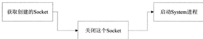
图 8-1 启动 System 进程前的准备工作
